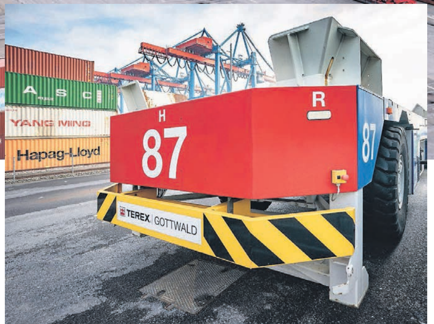
Die automatischen Containertransportfahrzeuge (AGV) sind ein wichtiger Baustein für die Klimaneutralität am CTA.
