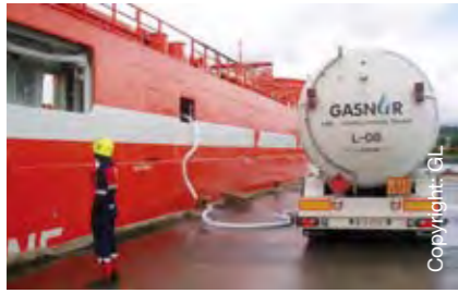
Mobile LNG refuelling in Brunsbüttel
