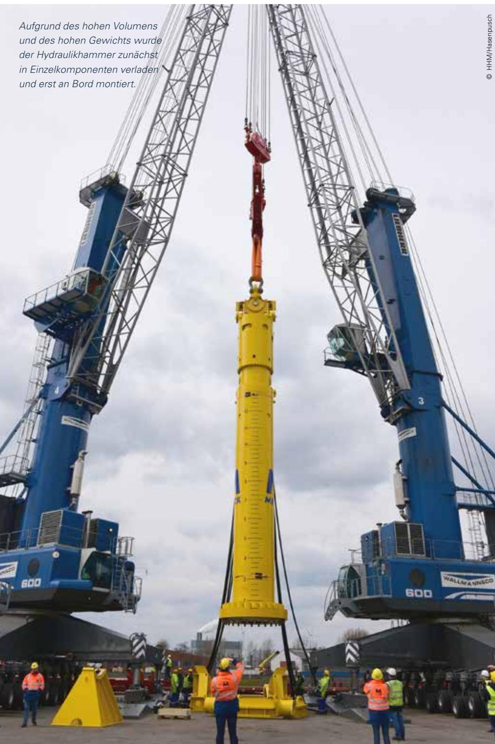
Im niedersächsischen Osnabrück wurde für den 580 Tonnen schweren Giganten eine Pfahlführung gebaut, die aus Ober- und Unterteil besteht. Das größere der beiden Teile hatte einen Durchmesser von knapp 7,60 Metern und ein Gewicht von über 37 Tonnen.
