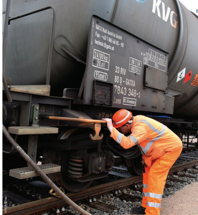
Wagenmeister Fred nimmt den Kesselwagen genauestens unter die Lupe. Anhand der Label erkennt er, dass in dem Wagen entzündliche und umweltgefährliche Stoffe geladen sind.
