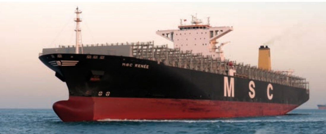
Die durchschnittlichen Umbaukosten von 600.000 Dollar beim Austausch des Bugwulstes sind bei den aktuell niedrigen Brennstoffpreisen in rund zwei Jahren wieder reingefahren.
